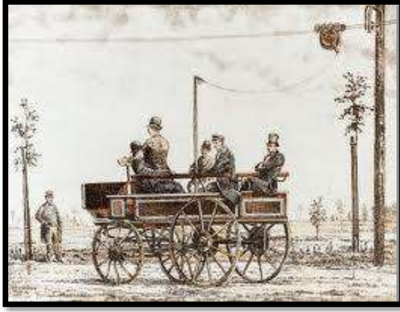
Şekil 1 Berlin'de Werner Von Siemens tarafından Electromote adı verilmiş olan ilk trolleybüs (Kaynak: http://en.wikipedia.org/wiki/Trolleybus )
